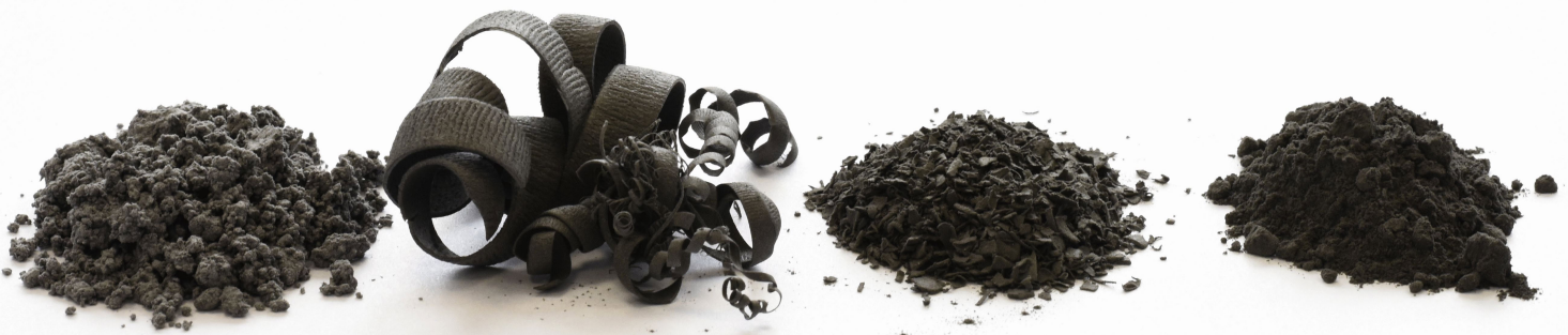
Im Gegensatz zu den meisten anderen Thermoplasten können bei PTFE nicht einfach Flakes der Neuware zugemischt werden (v.l.n.r. Original-Pulvermischung, Späne, zerkleinerte Späne, Mahlgut) © Staskol
